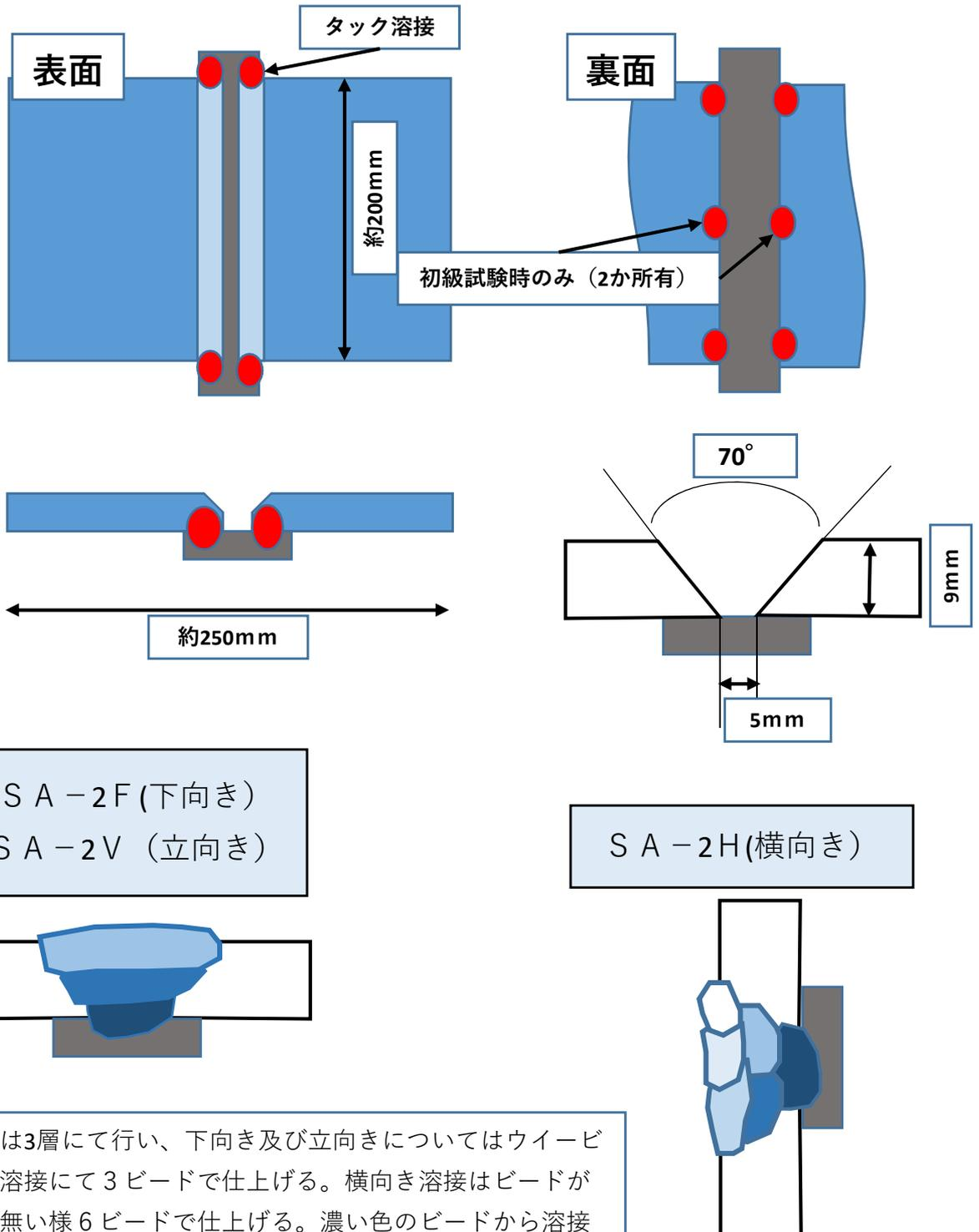
溶接は3層にて行い、下向き及び立向きについてはウイーピング溶接にて3ビードで仕上げる。横向き溶接はビードが垂れ無い様6ビードで仕上げる。濃い色のビードから溶接
